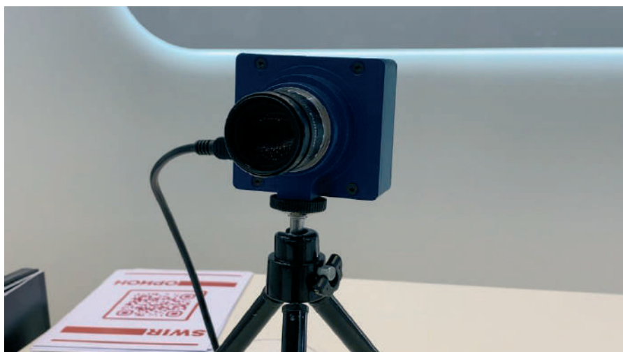
Камера коротковолнового инфракрасного диапазона SWIR (НПО «Орион»). Фото: «Швабе»
