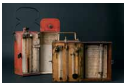
Рисунок 2 – Высотомеры из музея-архива Д. И. Менделеева в СПбГУ. Изготовлены по заданию ученого в 1875–1876 гг. в мастерских механиков Брауэра и Рихтера. Ссылка: https://spbu.ru/universitet/muzei-i-kollekcii-spbgu/muzey-arhiv-d-i-mendeleeva
