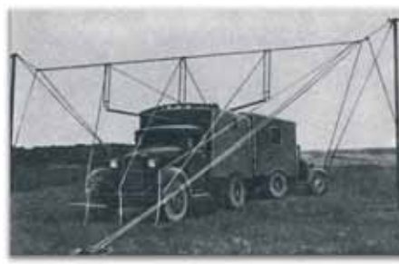
Рисунок 6 – а) Передатчик и б) приемник РУС-1 «Ревень» – первый советский серийный радиолокатор. Принят на вооружение в 1939 году, использовался войсками ВНОС РККА. Произведено 45 комплектов.
