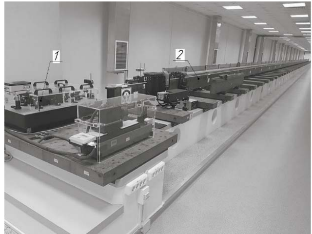
Рисунок 5 - Интерферометрический калибровочный стенд длиной до 60 м
