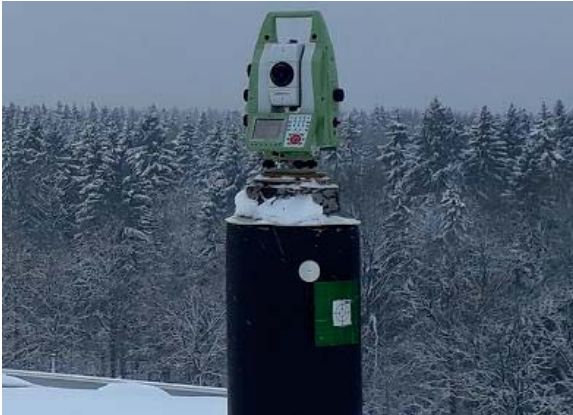
Рисунок 2 - Электронный тахеометр из состава ГЭТ 199 – 2012 на геодезическом базисе
