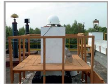
Рисунок 4 - Эталон сравнения на основе приемников КНС и опорных базисных пунктов в диапазоне 1 км - 4 000 км
