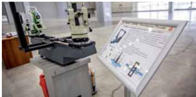
*Установка для поверки геодезических угломерных приборов – часть экспозиции Главного центра*
