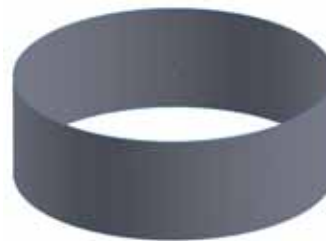
Рисунок 8 – Геометрическая модель обечайки с эквивалентной гладкой оболочкой
