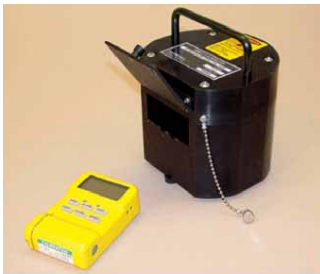
Рисунок 3 – Портативное поверочное устройство FC2B и индивидуальный дозиметр UltraRadiac
