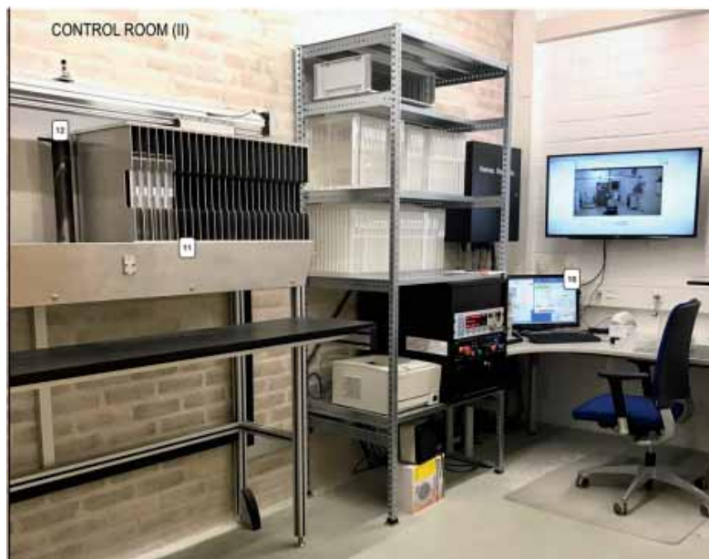
Рисунок 2 – Комната загрузки дозиметров в рамки управления и контроля процесса поверки
